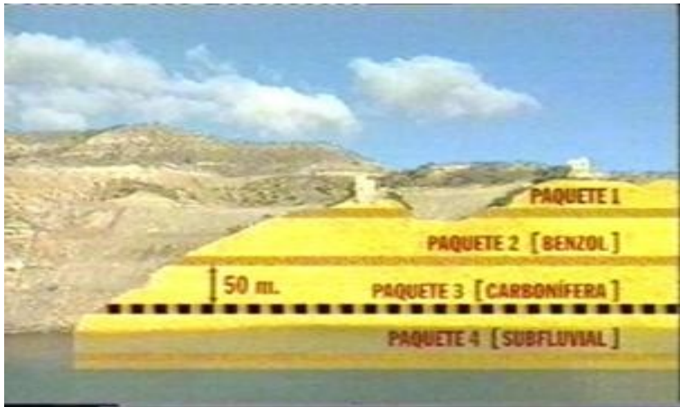
Figura 2. Secció estratigràfica idealitzada dels diferents paquets explotables de la conca carbonífera de Mequinensa-Baix Segre, prenent com a referència el nivell del riu Ebre a l'alçada de la mina Virgen del Pilar de l'empresa Carbonífera del Ebro, S.A. (PÉREZ, 2006).
