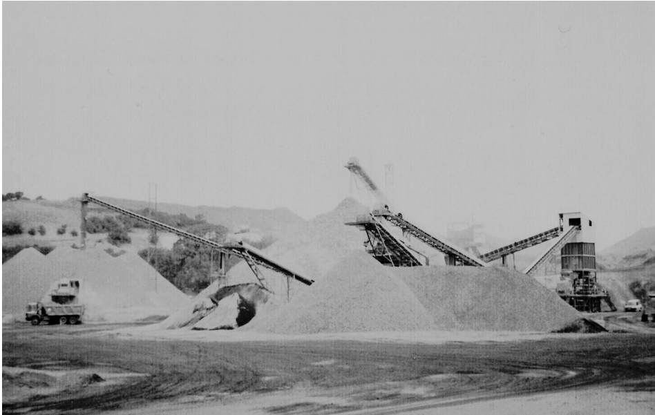
Foto 1. Planta de selecció d'àrids porfídics de la pedrera "Soriana" situada a poca distància de les mines de manganès d'Estopanyà. (Arxiu autor, juny 2002).
