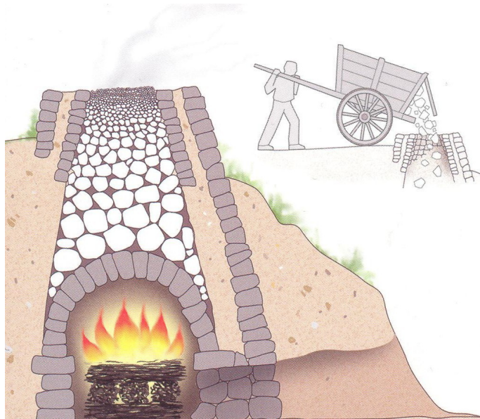
Figura 6. Secció d'un forn de calç tradicional i forma de carregar-lo per l'obertura superior. Procedència de la il·lustració: V.V.A.A. (2008). Guia de geologia de Collserola, Parc de Collserola, Diputació de Barcelona, pp. 153, Barcelona.
