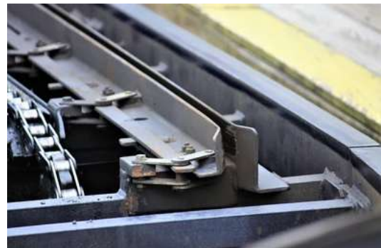
imatge 45. Sistema de frens d'aleta, on es poden observar les plaques per les quals es paren els vagons. Imatge extraïda de https://www.shutterstock.com/es/image-photo/close-roller-coaster-friction-brake-parts-774412159
