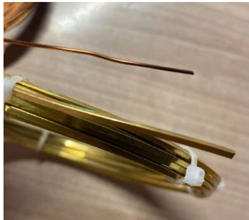
Imatge 130. Filferros per a la maqueta. A dalt, el de les vies, a baix, el de la biga. Imatge pròpia.
